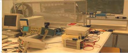
Au LSIS Marseille Un banc d'essai composé d'une éolienne à 2 pales coniques et d'un système d'acquisition de données et de traitement de données est disponible au LSIS. Des outils de simulation (carte DSP D-space) viennent compléter ce matériel pour permettre l'étude de dimensionnement et de prototypage virtuel. La génératrice est simulée sous Matlab Simulink. On adjoindra à ce système des panneaux photovoltaïques et un système de stockage de l'énergie sous forme électrique.
